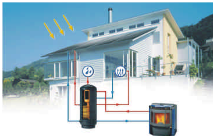
Fig.4 Combinato solare e biomassa
